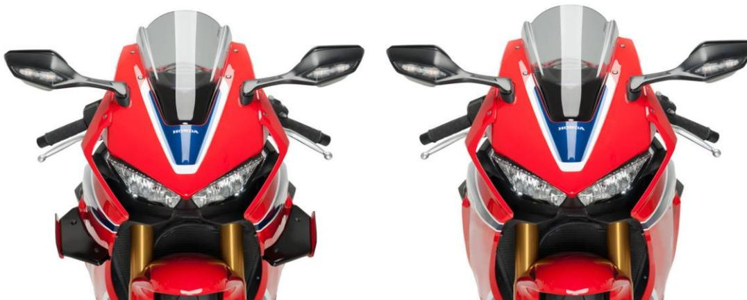
Der Vergleich an einer Honda CBR1000RR, links mit Winglets, rechts Serie
