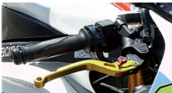
7) TITAX-Hebel am Motorrad. Überprüfen Sie Funktion und Position der Bremshebel-Einstellung. Überprüfen Sie die Funktion der Bremsleistung
