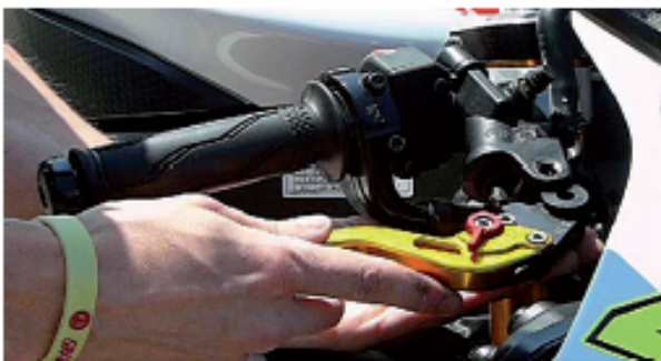
6) Geben Sie während der Montage acht auf den Bremslichtschalter (wenn es einen hat). Verwenden Sie Schraubenschlüssel und Schraubendreher um Mutter und Schraube, die den Hebel halten, wieder zu montieren. Verwenden Sie 6-10 Nm Drehmoment, wenn die Schrauben angezogen sind und berücksichtigen Sie die Angaben im Motorradhandbuch des Herstellers zur Bestätigung. Überprüfen Sie die Funktion des Bremslichtschalters und finden Sie die richtige Position für die Einstellung des Bremshebels. Der Hebel muss beim ersten Drittel Ihrer Finger einrasten, dann ist er perfekt montiert und eingestellt.
