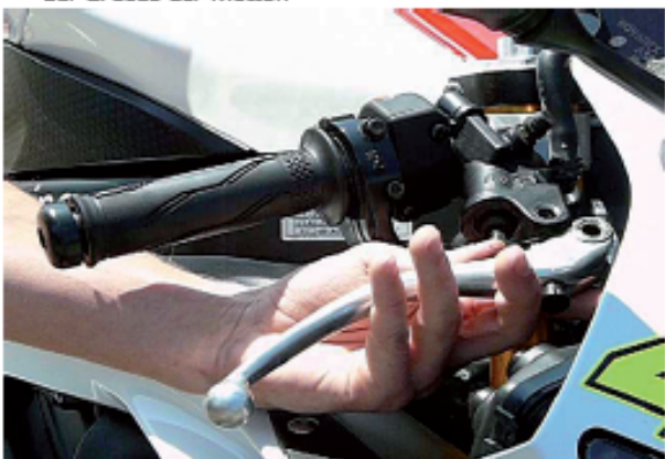
3) Entfernen Sie Schraube, Mutter und Originalhebel.
