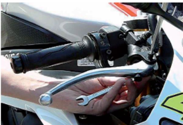
2) Verwenden Sie Schraubenschlüssel und Schraubendreher um Mutter und Schraube, welche den Hebel halten, zu lösen. Verwenden Sie den Schraubenschlüssel passend zur Größe der Mutter.
