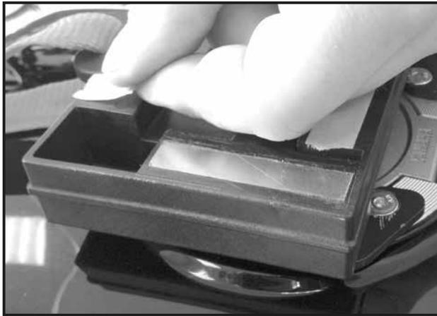
Verschlusseinheit auf montierten Tankring/Lock-it Pfeil aufsetzen, bis diese fühlbar einrastet.
