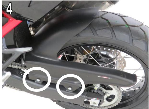
7. Befestigen Sie die Hinterradabdeckung am Halter mittels der M6x18 Schraube (6) Abb.5 / Secure hugger on the bracket using M6x18 (6) Fig.5
