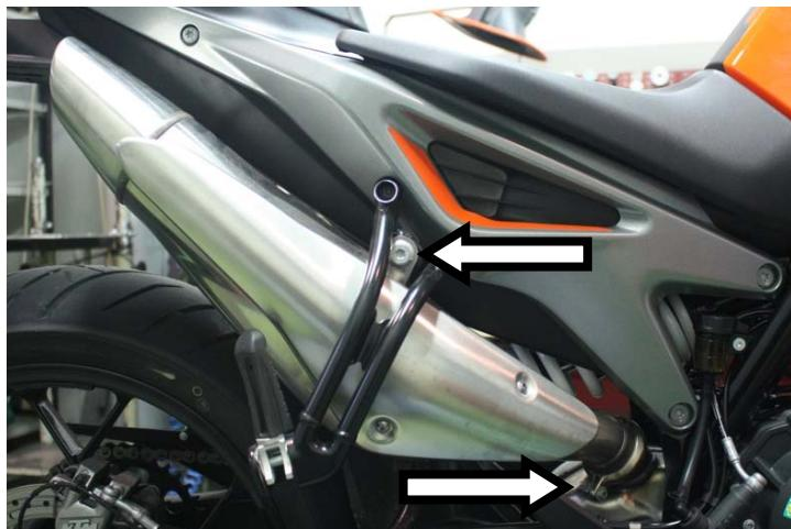
**IT** · Svitare la fascetta, la vite di fissaggio e rimuovere il terminale
