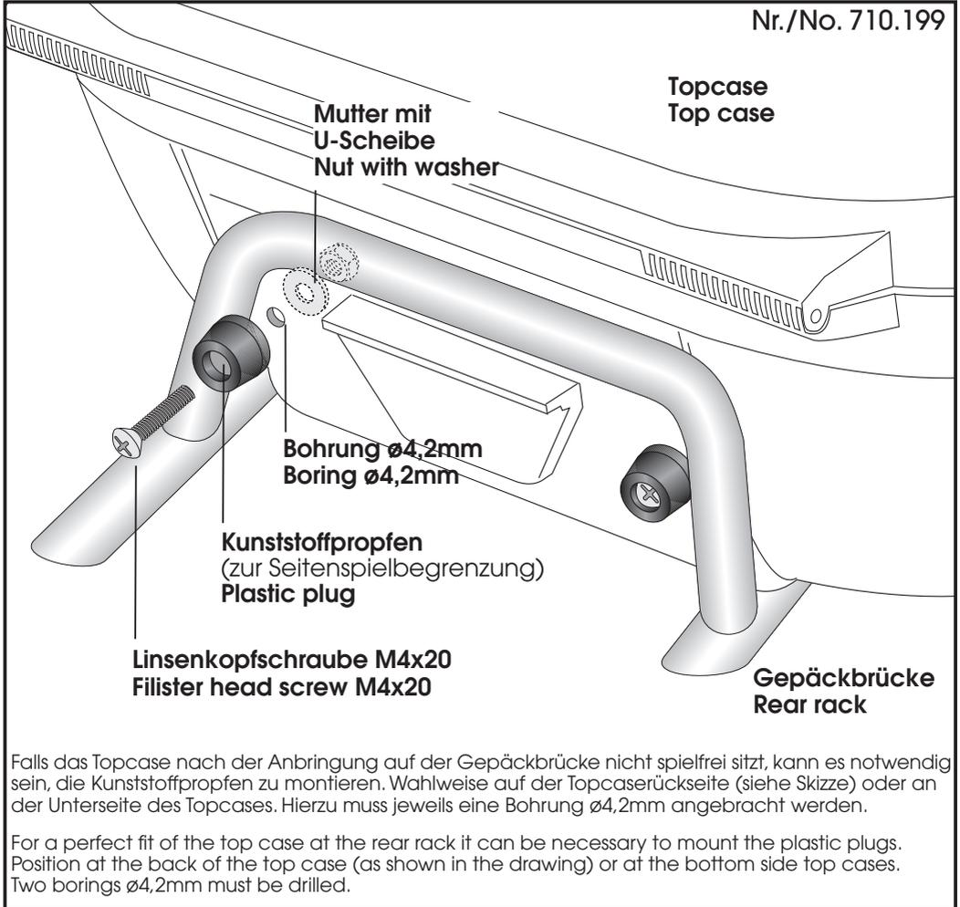
Falls das Topcase nach der Anbringung auf der Gepäckbrücke nicht spiefrei sitzt, kann es notwendig sein, die Kunststoffpropfen zu montieren. Wahlweise auf der Topcaserückseite (siehe Skizze) oder an der Unterseite des Topcases. Hierzu muss jeweils eine Bohrung  $\varnothing 4,2\text{mm}$  angebracht werden.
