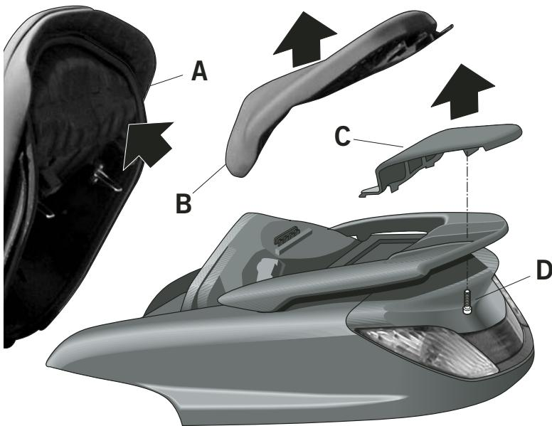
(E) Abrir el asiento (A). Desmontar el asiento trasero (B). Desmontar la tapeta (C) del carenado posterior mediante los tornillos (D).
