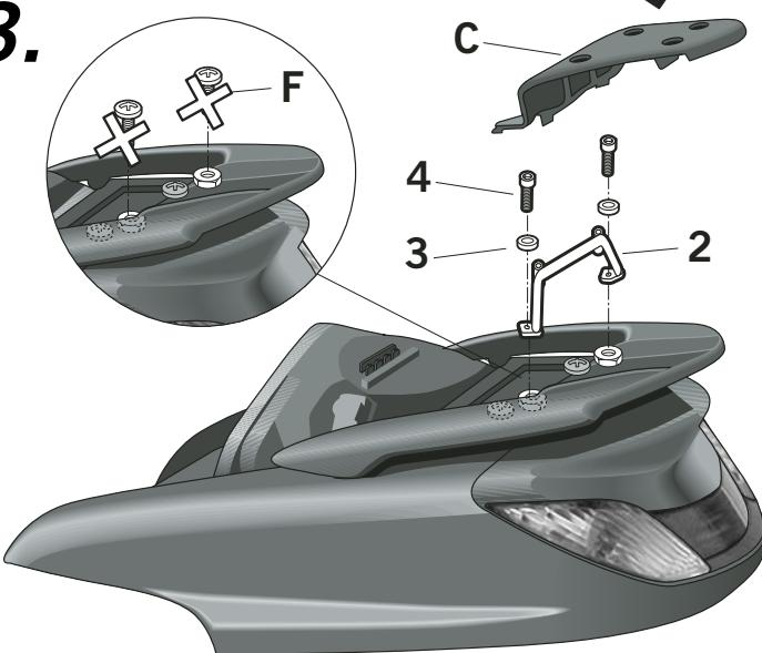
(E) Desmontar y desestimar los tornillos (F). Montar el soporte varilla (2) mediante las arandelas (3) y los tornillos (4). Montar la tapeta (C).
