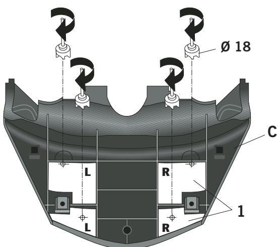
(E) Recortar las plantillas (1), colocarlas en la tapeta (C) según nos muestra la figura (E), marcar los centros y realizar los cuatro agujeros de Ø18. (Nota: Recomendamos no realizar el agujero de Ø18 de una sola vez, sino ir realizando de Ø inferiores hasta llegar al Ø de 18).
