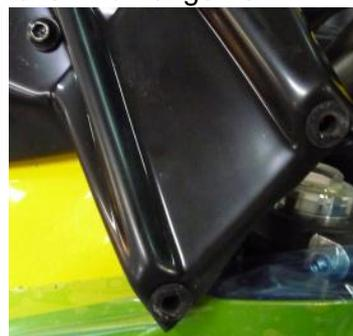
Im letzten Schritt legen Sie die Ermax Scheibe an den Ermax Halter an und verschrauben diese mittels der M5x15 Schrauben und Unterlagescheiben.
