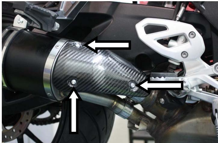
**IT** · Montare la protezione interponendo con gli attacchi le rondelle para calore.
