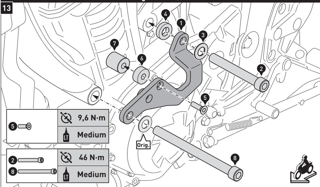
**ACHTUNG:** Beginnen Sie mit der Montage des rechten Sturzpads erst, wenn Sie die Montage des linken Sturzpads abgeschlossen haben!
