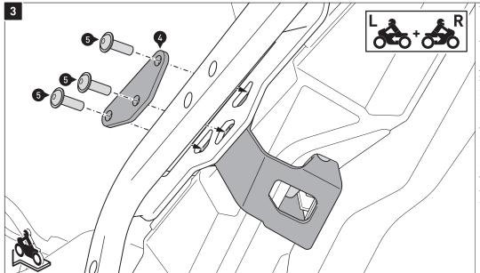
Verschrauben Sie die Sicherungsblech-Einheiten mit den Kofferträgern, wie in der Zeichnung gezeigt. Achten Sie darauf, dass sich bei der Montage nicht die Position der Distanzbuchsen verändert.
