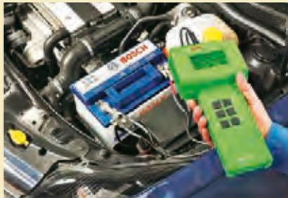
Kälteprüfstrom messen: Die Werkstatt kann so den Zustand der Batterie erkennen
