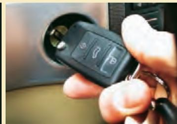
Starten: Dreht der Motor nur müde durch, ist die Batterie zu schlapp
