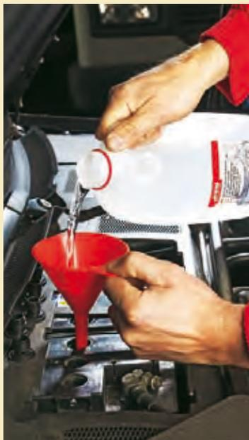
Batterie mit Stopfen: mit destilliertem Wasser auffüllen
