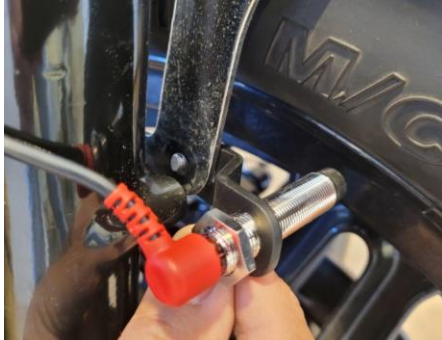
Schutzblechschraube, die zur Positionierung des Geschwindigkeitssensors neben der Felge benutzt wird
