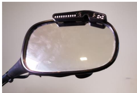
Ein korrekt installierter Warnblinker.
