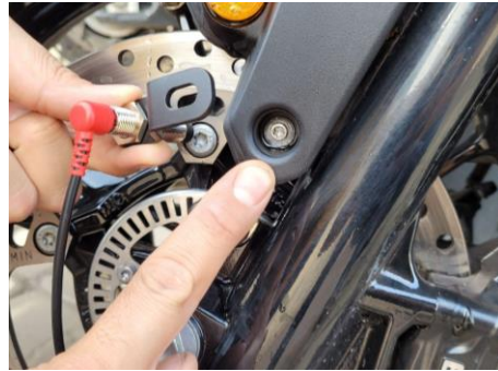
Schutzblechbolzen zur Positionierung des Geschwindigkeitssensors neben einer Bremsscheibenschraube
