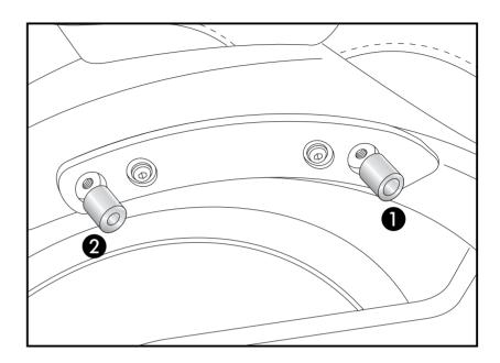
Montage der C-Bows: die vorbereiteten C-Bows werden nun am Motorradrahmen über der Blende verschraubt. Fastening of the C-Bows: screw on the prepared C-Bows to the bike.
