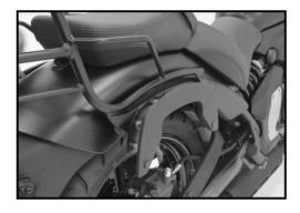
Bei zusätzlicher Montage einer Sissybar wird diese zuerst montiert. Der C-Bow wird außen auf den Laschen der Sissybar ohne Distanzen mitverschraubt. Hierzu die Schrauben aus diesem Kit verwenden.
