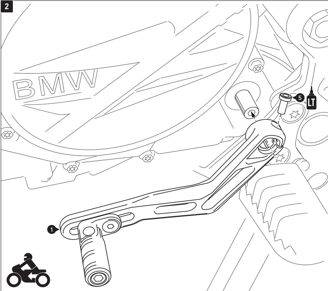
Lösen Sie die Schraube der Schalthebelklemmung und entfernen Sie den Original-Schalthebel vom Fahrzeug.
