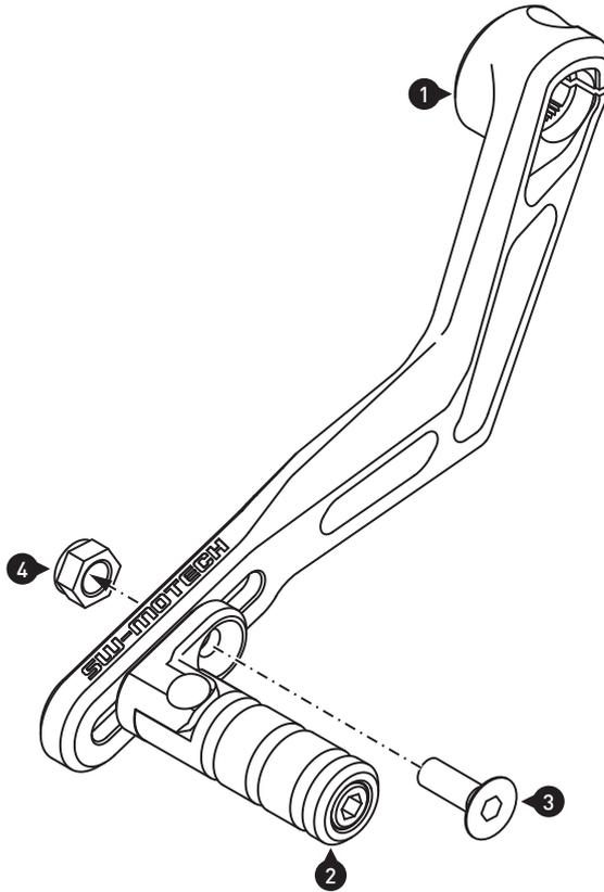
Verschrauben Sie die gezeigten Teile am Schalthebel (1), wie in der Zeichnung dargestellt. Ziehen Sie die Schraube noch nicht an.
