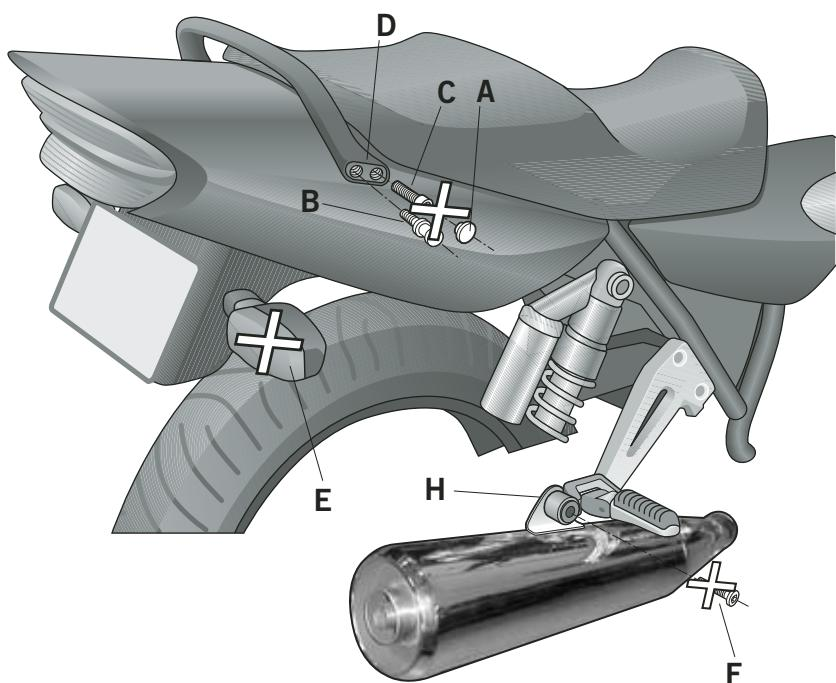
(E) Desmontar y desestimar los tapones (A). Desmontar y desestimar los tornillos mecanizados (B) y los tornillos (C) en la zona (D) del agarradero. Desmontar y desestimar los intermitentes traseros (E). Desmontar y desestimar los tornillos (F), en zona fijación tubo de escape (H).
