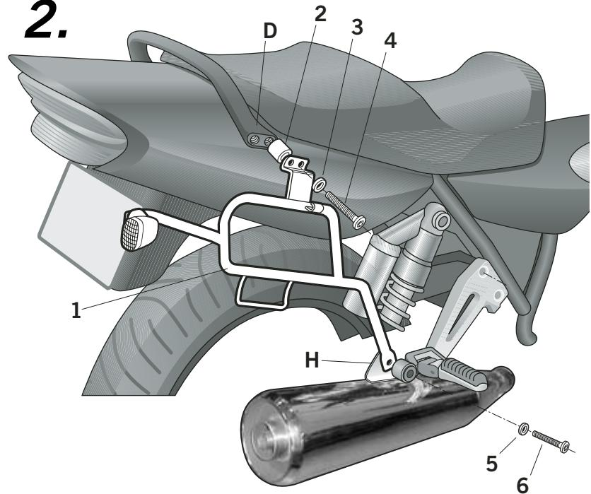
(E) Montar los soportes KIT SIDE (1) en zona (D), mediante los distanciadores (2), arandelas (3) y los tornillos (4), y en zona fijación tubo de escape (H), mediante las arandelas (5) y los tornillos (6).
