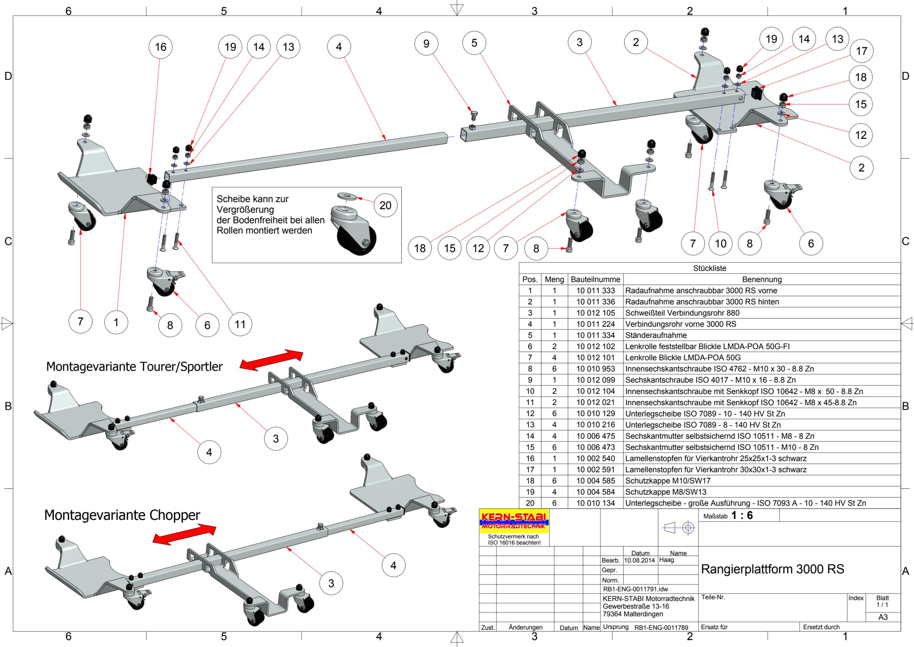
Scheibe kann zur Vergrößerung der Bodenfreiheit bei allen Rollen montiert werden
