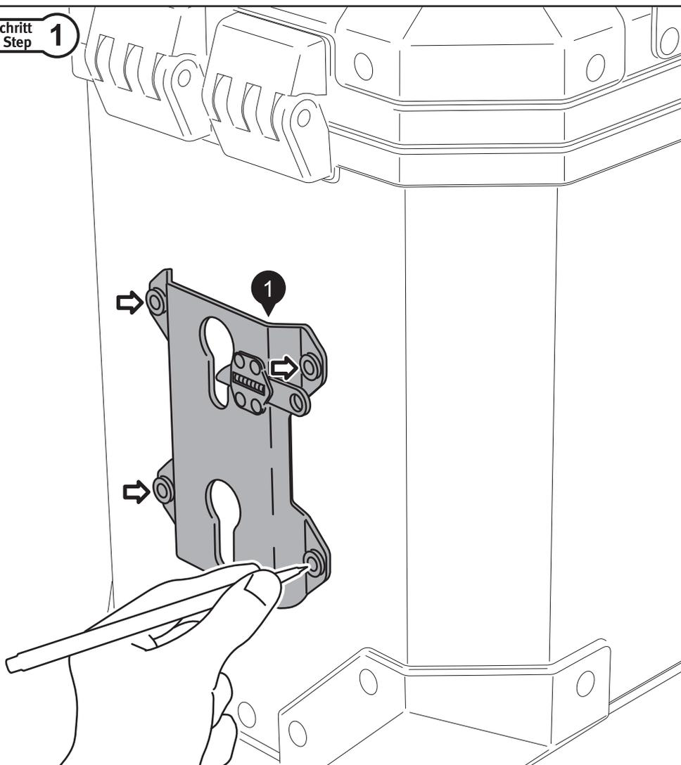
Legen Sie den Universal-Halter (1) auf das Gehäuse die TraX ® EVO ALU-BOX. Markieren Sie mit einem wasserlöslichen Marker die vier Bohrpunkte.
