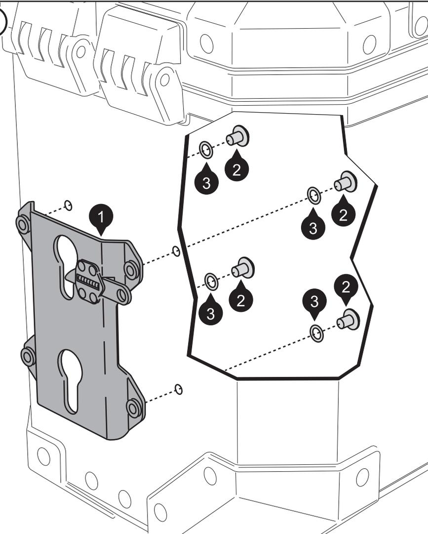
Verschrauben Sie nun den Universal-Halter (1) von der Innenseite der TraX® EVO ALU-BOX. Sichern Sie die Schrauben (2) mit flüssiger Schraubensicherung.
