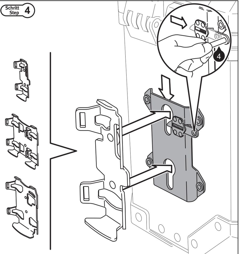
Setzen Sie nun das von Ihnen gewählte Halteblech in den Universal-Halter (1) ein. Drücken Sie das Halteblech nach unten, bis diese sicher einrastet.
