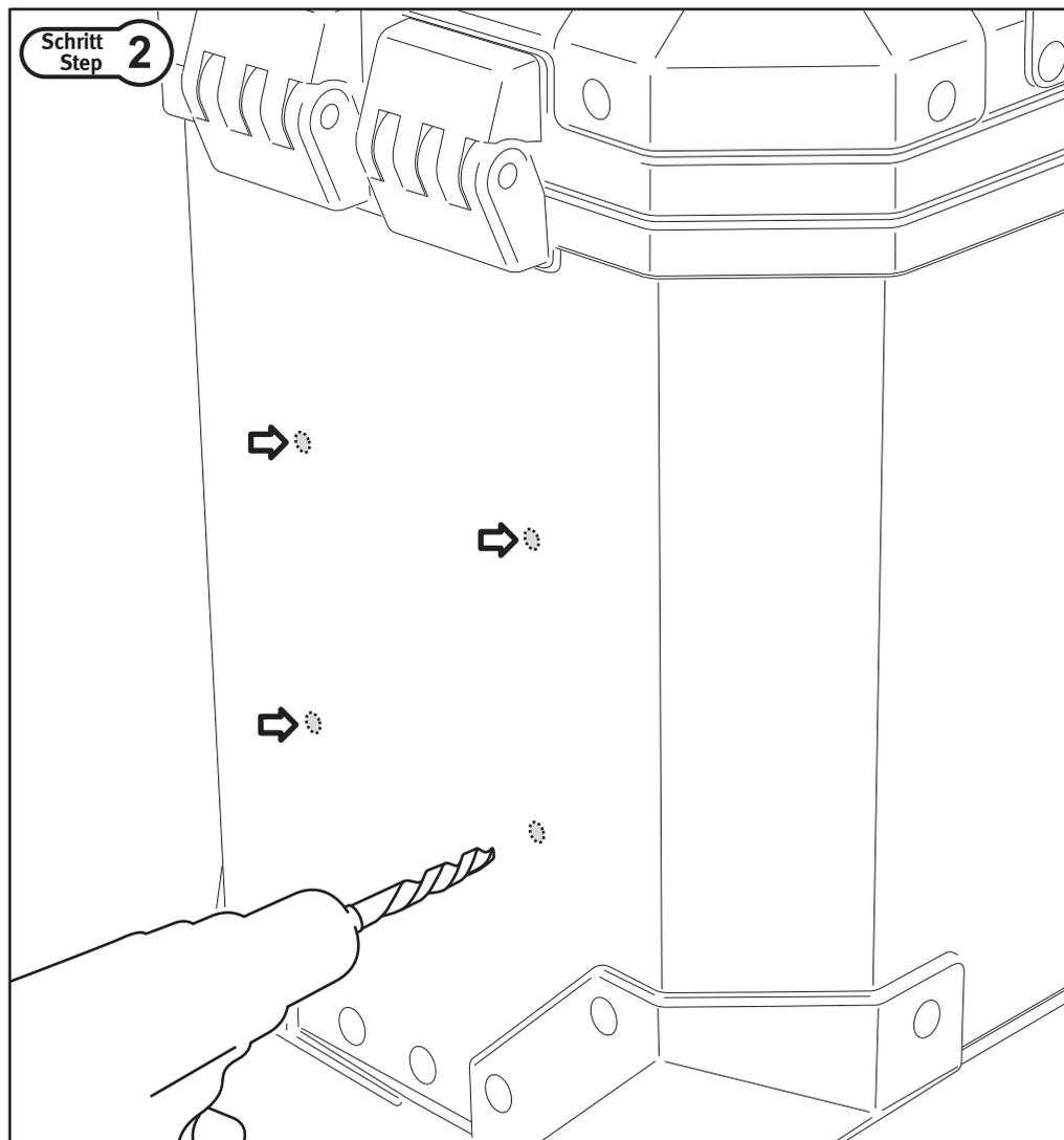
Nutzen Sie einen 5,5-mm-Bohrer, um das Gehäuse der TraX ® EVO ALU-BOX an den markierten Stellen aufzubohren. Entgraten Sie anschließend die Ränder der Bohrlöcher
